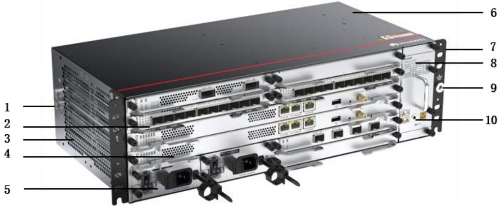
1. 接地端子（后侧）    2. PIC    3. 进风口    4. IPU    5. 交流电源模块
