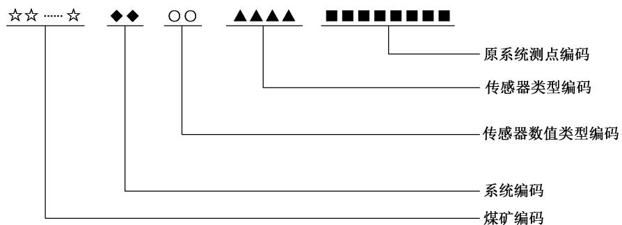
图A.1 测点编码格式及含义示意图
